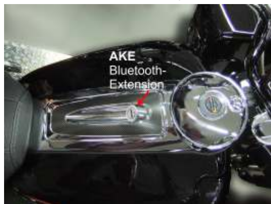
Einbau in die Tankabdeckung an Stelle der Helmanschlussbuchse für den Fahrer
